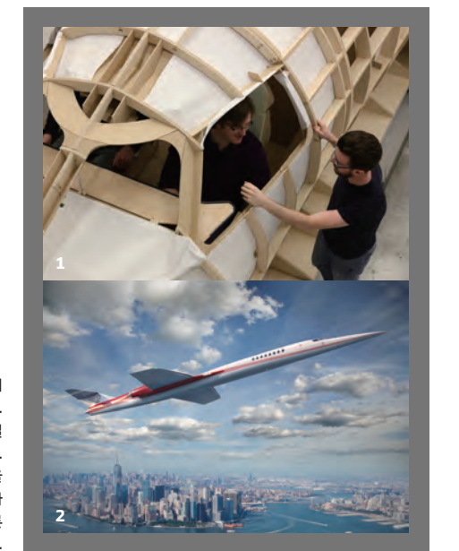
1 엔지니어들이 AS2의 목업을 제작하고 있다. 조종석의 직경은 객실 부위보다 조금 더 작다. 2 AS2는 런던-뉴욕 구간을 기존 여객기(7시간)보다 2시간 36분 빠른 4시간 24분에 끊을 수 있다.
