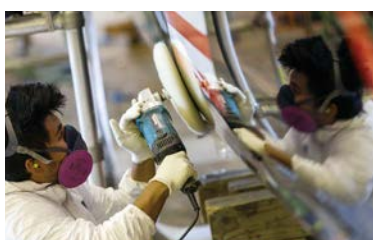
디펜더(지난 대회 챔피언)인 오라클 팀 USA의 AC72 경기정 건조 장면. 탄소섬유 복합재로 만든 윈 세일의 형상은 비행기 날개와 흡사하다(위). 가로대로 결합한 조립한 유선형의 선체 내부 구조를 작업(가운데). 자동차 광택 작업과 비슷해 보이는 과정은 유체 저항을 최소화하기 위한 작업이다(아래). ©GUILAIN GRENIER/ORACLE TEAM USA
